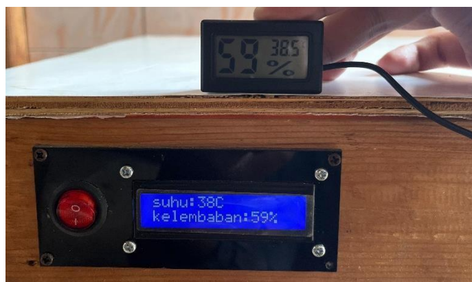
Gambar 5. Uji Coba Akurasi Sensor DHT11 dan Termometer Digital
