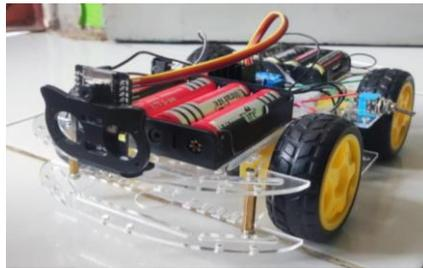
Gambar 5. Hasil Perakitam Mobil RC Pengawas *Real Time*
