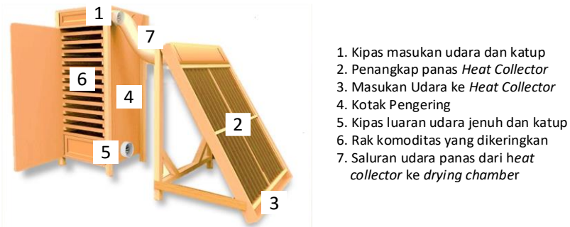
Gambar 4. Pengumpul panas matahari dan Kotak Pengering
