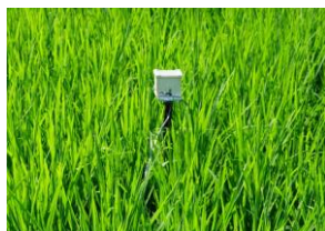
Gambar 9. Uji coba sensor kelembapan tanah di lahan
