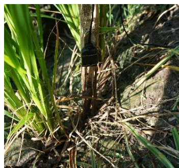
Gambar 8. Uji coba sensor kelembapan tanah di lahan
