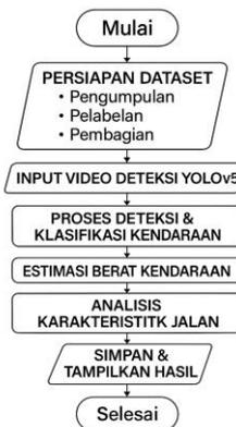
Gambar 3. Flowchart Proses Analisis Beban Kendaraan terhadap Karakteristik Jalan menggunakan Metode YOLOv5
