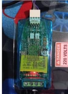
Gambar 4. Uji Coba Sensor PZEM
