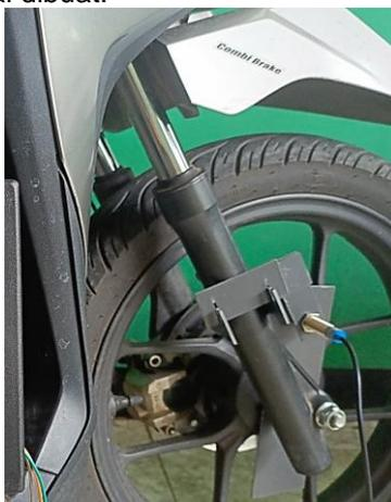
Gambar 6. Hasil Tampilan Penempatan Sensor Pada Sepeda Motor
