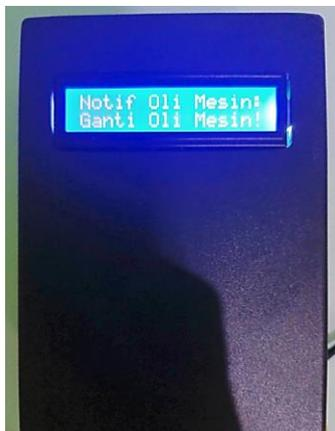
Gambar 9. Hasil Tampilan Alat Notifikasi Ganti Oli Mesin
