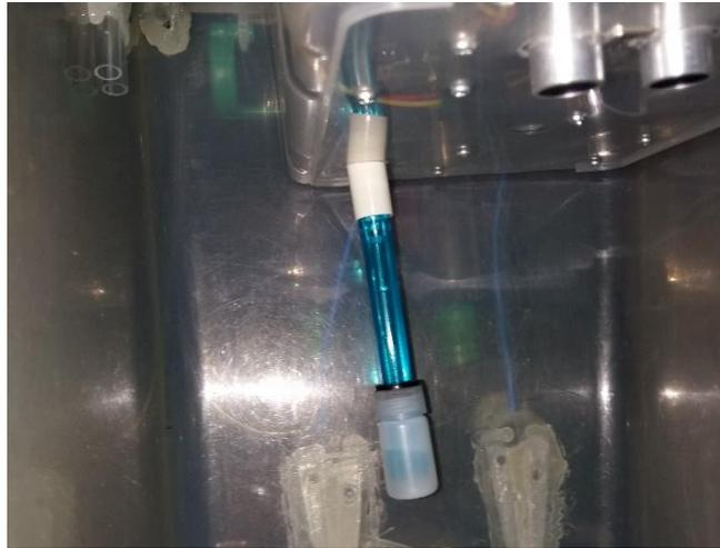
Gambar 8. Peletakan Sensor Analog pH Meter
