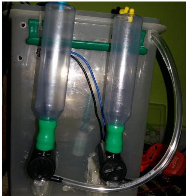
Gambar 5. Pembuatan dan Pemasangan Pompa Air Mini DC 12V
