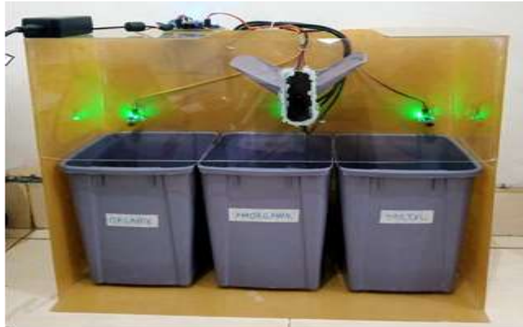
Gambar 5. Perancangan Mekanik Tempat Sampah Pintar
