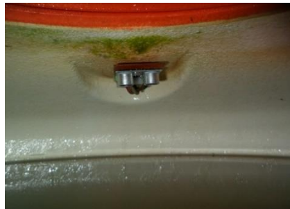
Gambar 9. Sensor tampak samping pada saat level air seratus persen
