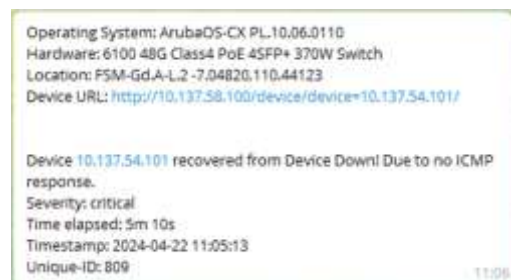
Gambar 7. Notifikasi perangkat pada Chat Bot Telegram .
