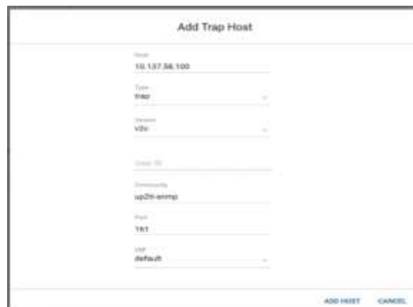
Gambar 25. Menambahkan Trap Host pada perangkat.
