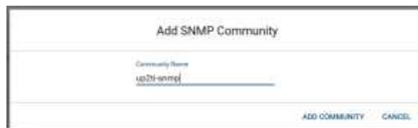
Gambar 24. Menambahkan SNMP Community pada perangkat.
