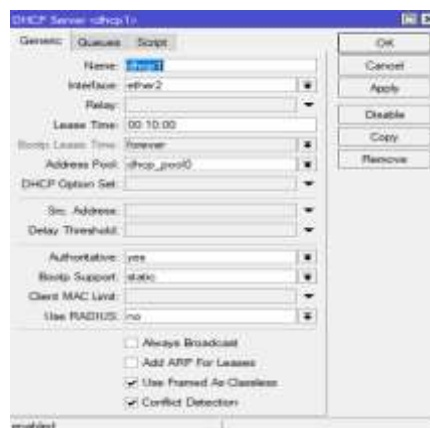
Gambar 10. Membuat DHCP Server pada mikrotik
