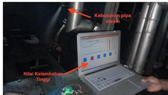
Gambar 11. Tata letak Sensor dan Mesin Calendering
