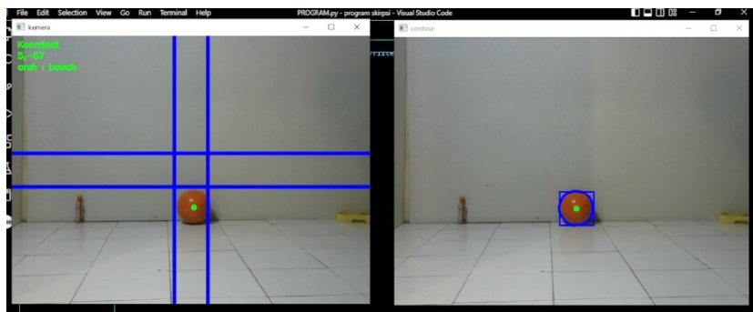
Gambar 7. Hasil deteksi bola pada arah bawah (skenario keempat)
