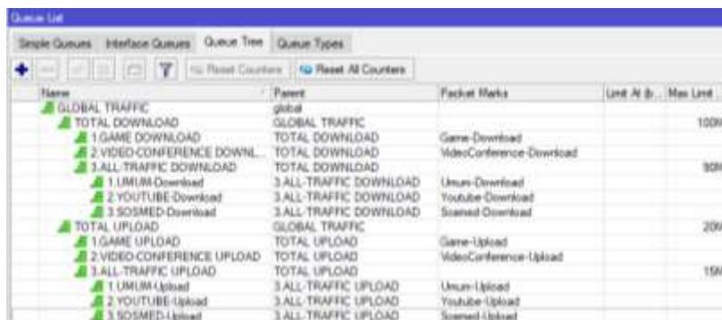
Gambar 11. Konfigurasi Queue Tree
