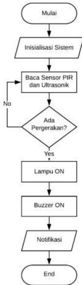
Gambar 2. Flowchart deteksi penyusup
