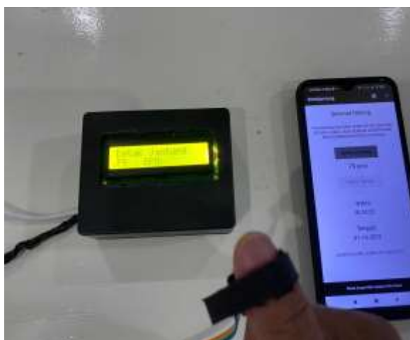
Gambar 2. Tampilan Prototype Alat Deteksi Detak Jantung Yang Dikembangkan
