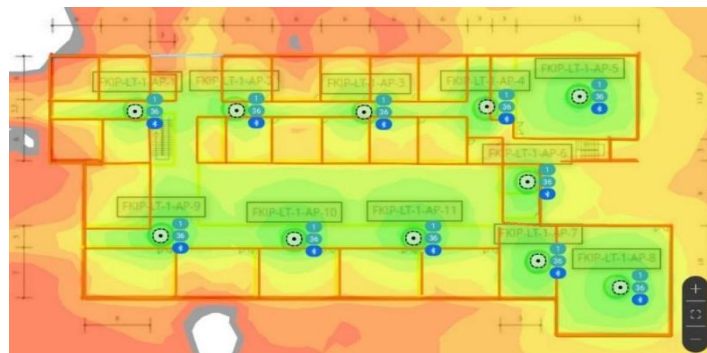
Gambar 3. Penempatan access point dan penyebaran sinyal Wi-Fi lantai 1
