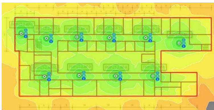
Gambar 4. Penempatan access point dan penyebaran sinyal Wi-Fi lantai 2
