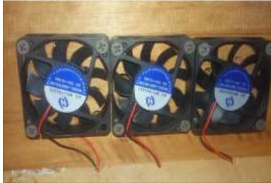
Gambar 5. Instalasi Rangkaian Kipas DC
