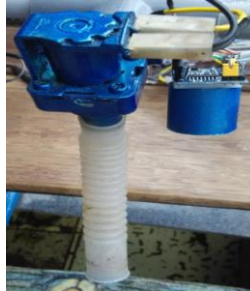
Gambar 3.4 Pemasangan Sensor PIR dan Selenoid valve wudhu
