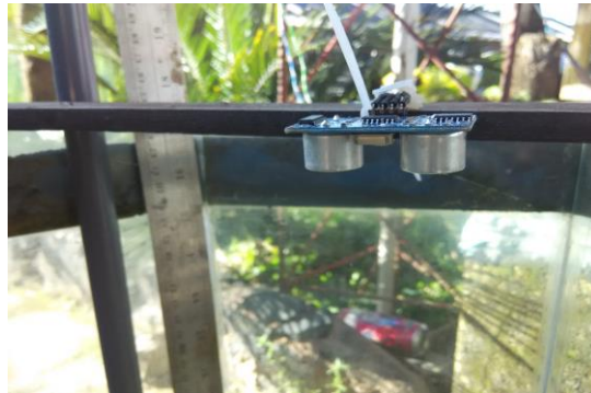
Gambar 3.1 Pemasangan sensor ultrasonik
